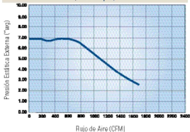
**DFO 3-3** 5HP 60Hz con 9 pulg. ducto de entrada (filtro limpio)
